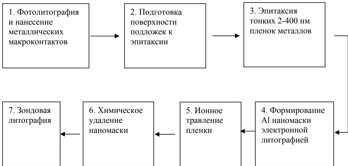
Рис. 2.2. Маршрут изготовления металлических эпитаксиальных наноструктур.
