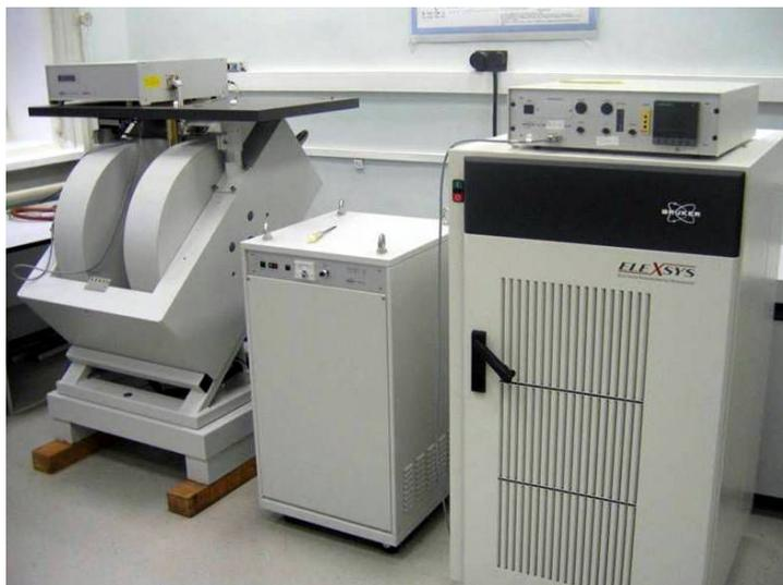
Рис. 2.1. ЭПР-спектрометр Bruker ELEXSYS E500
