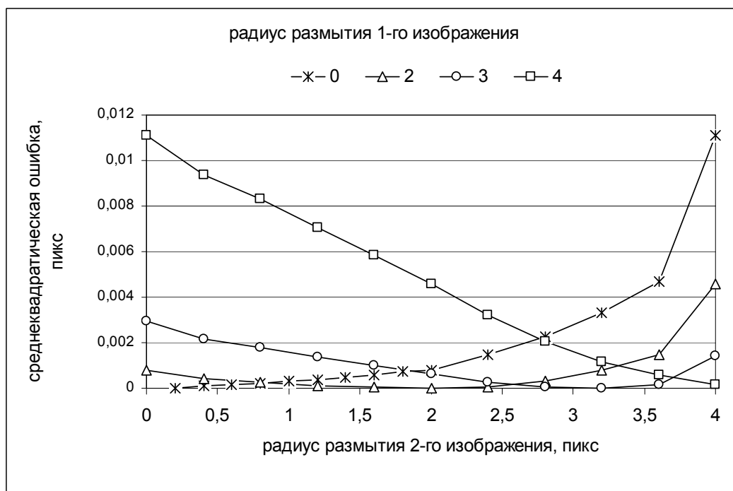
Рис.3.2.9. Зависимость величины шума от степени размытости одного изображения при фиксированном значении размытости второго. Четыре кривые соответствуют значениям фиксированного радиуса размытия одного из изображений – 0, 2, 3, 4.
