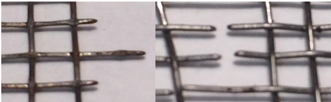
Рис. 3.41. Характер разрыва проволок для предварительно обжатого (слева) и необжатого (справа) состояния.
