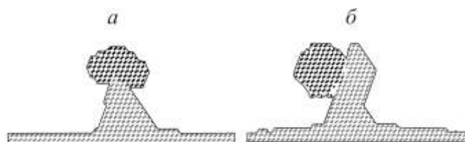
Рис. 3.2. Морфология нановискеров при механизме роста ПЖК и слабом смачивании между веществами вискера и катализатора (сечения модельной поверхности). Длительность роста: а – t=40 с, б – t=143 с. T=800 К, F=0.05 МС/с, E_{sub}(P)=0.1 эВ.
