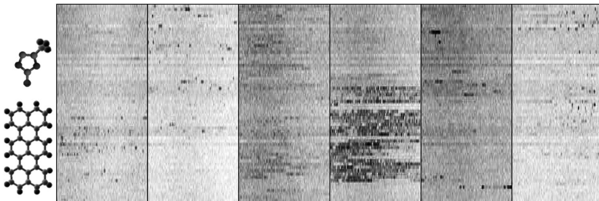
Рис. 5.16. Примеры спектральных траекторий для одиночных молекул террилена в пропилен карбонате. T=4,5\text{K} , диапазон сканирования составляет 30 ГГц, число спектральных точек на скан – 1000, время на одну спектральную точку – 30 мс, количество сканов в спектральных траекторий – 100.
