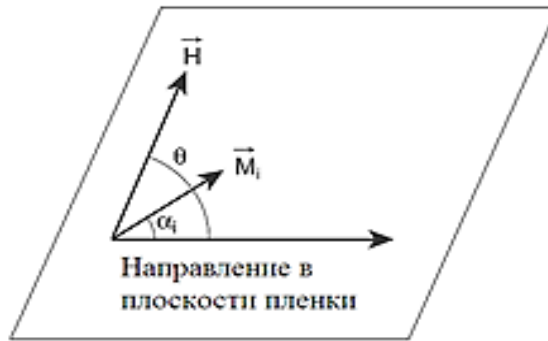
Рисунок 13. Углы \theta и \alpha_i отклонения направления внешнего поля и намагниченностей каждого слоя от выбранного в плоскости пленки направления [12].
