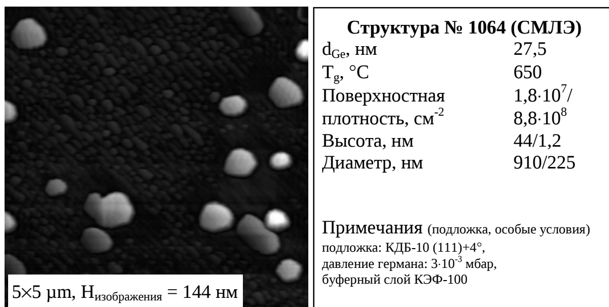
Рис. 73. Морфология и ростовые параметры структуры № 1064, полученной методом СМЛЭ в среде германа.
