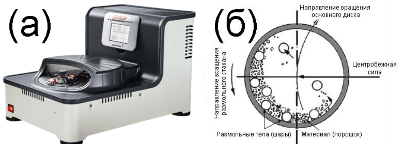
Рисунок 2.1 – (а) Внешний вид планетарной микромельницы и (б) принцип действия измельчения в планетарной мельнице. Изображение (б) адаптировано из [172]
