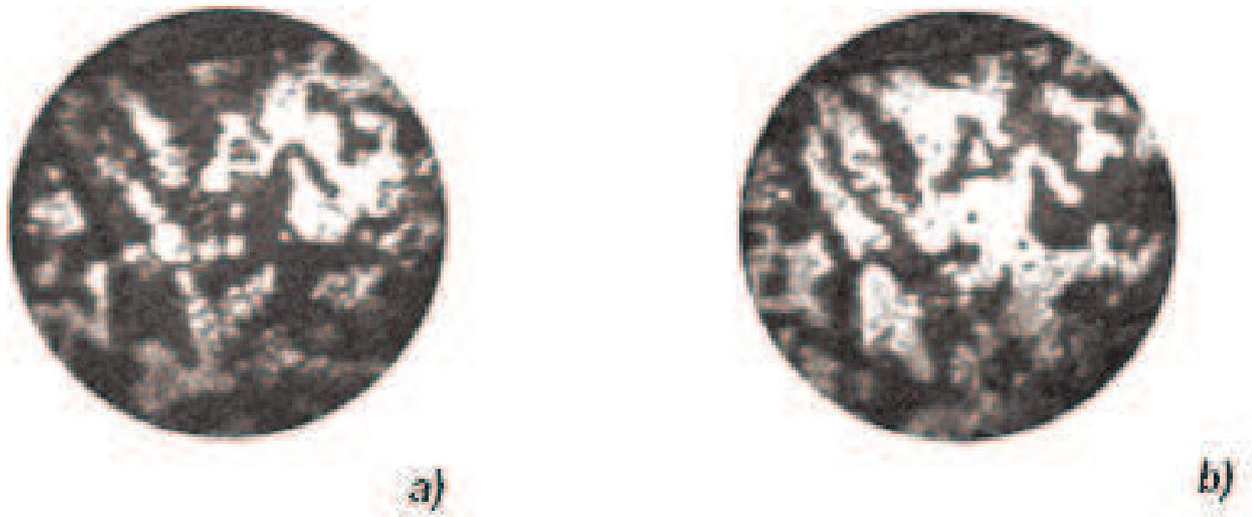
Рисунок 4.8. Изображения  $180^\circ$  антиферромагнитных доменов в  $\text{YFeO}_3$  для двух положений анализатора  $-40^\circ$  (a) и  $+40^\circ$  (b) [100, 185]
