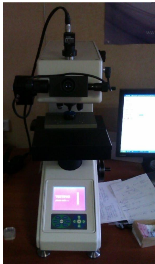
Рисунок 2.9. Общий вид микровердомера 402MVD Wolpert Wilson Instruments.
