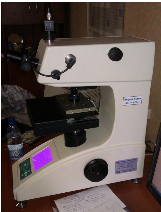
Рисунок 2.9. Общий вид микровердомера 402MVD Wolpert Wilson Instruments.
