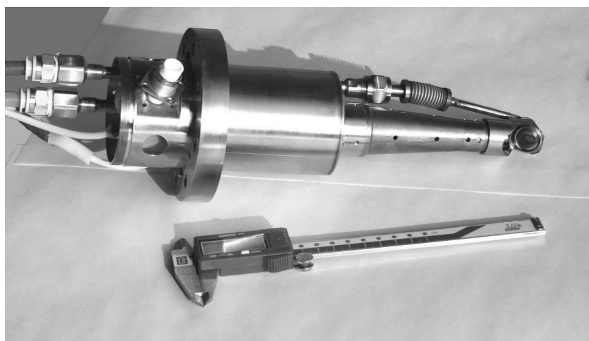
Рис.3.16. Внешний вид и габариты рентгеновской трубки.
