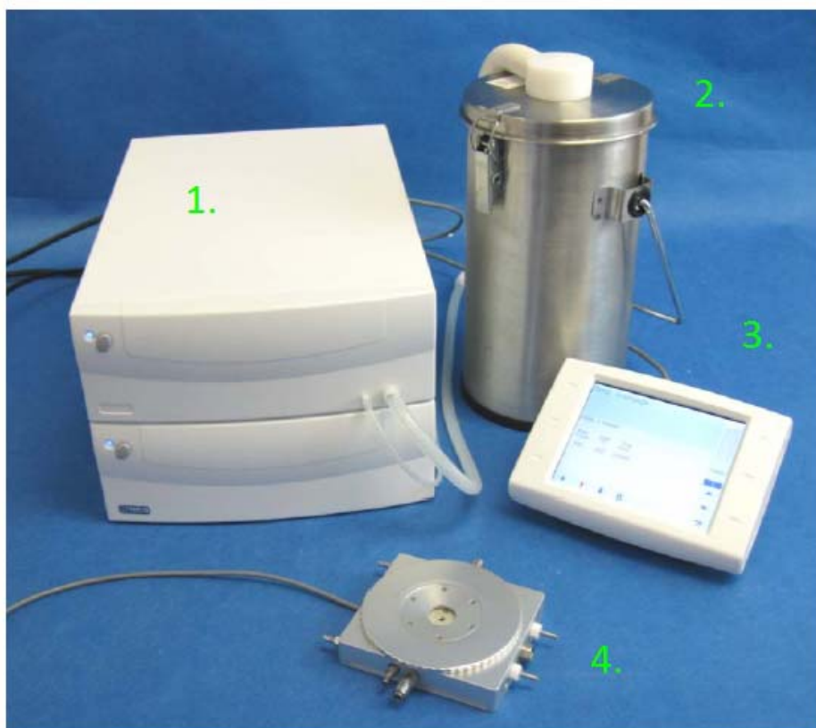
Рис. 2.4. Оборудование для температурных измерений. 1 – блок питания, 2 – криостат, 3 – сенсорная панель управления, 4 – температурная приставка для размещения образцов DSC600
