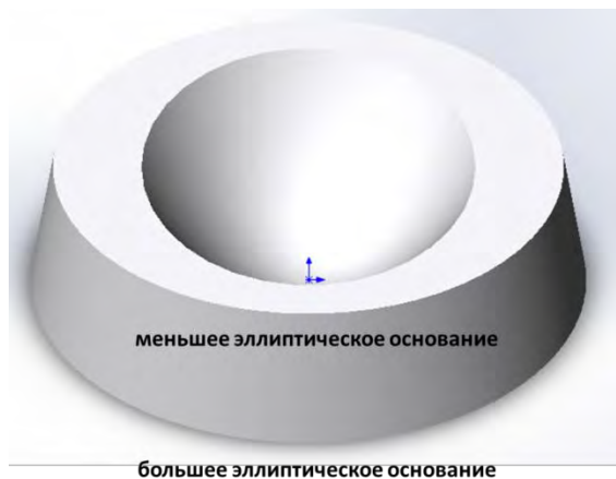
Рис. 2.7. Схематическое изображение двумерной линзы с погрешностями изготовления.
