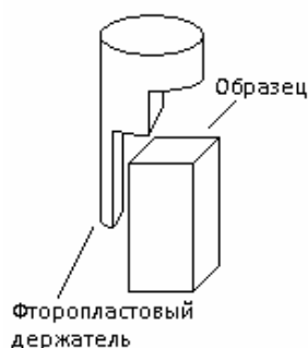
Рис. 2.9. Схематическое изображение системы фиксации образца с помощью фторопластового стержня внутри кварцевой трубки
