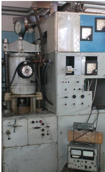
Рисунок. 2.10 Модернизированная установка диффузионной сварки УДС-10
