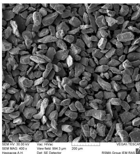
Рисунок. 2.5 Морфология порошка ниобия после сухого размола в течение 10 ч
