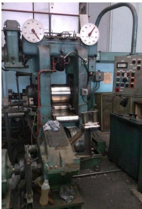
Рисунок. 2.9 Четырехвалковый прокатный стан Cvarto
