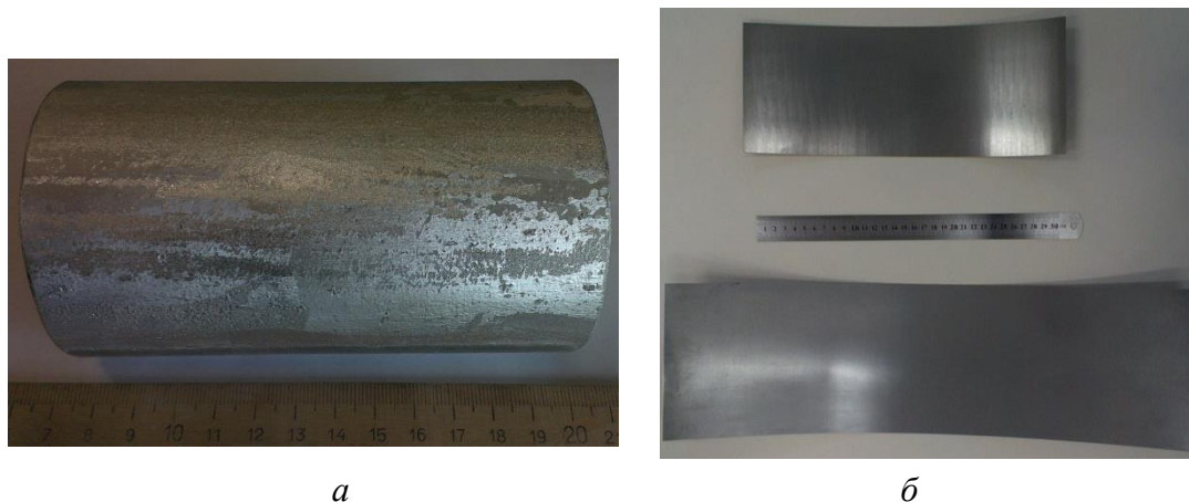
Рисунок. 2.3. Материалы для многослойной технологии: а – слиток алюминия А999, б – лист толщиной 0,4 мм из ниобия марки Нб-1
