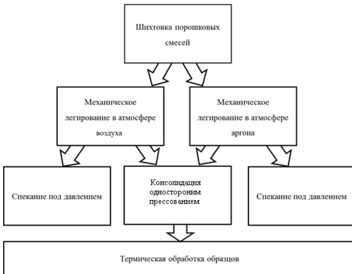
Рисунок. 2.6 Блок-схема технологии приготовления образцов методом механического легирования исходных порошковых смесей из ниобия и алюминия
