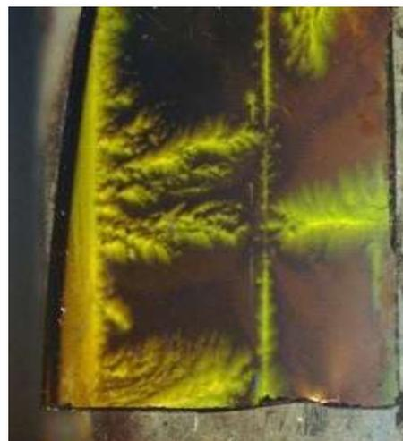
Рисунок 6.4.16 – МО изображение ВТСП ленты после проведения облучения высокоэнергетичными ионами Хе,  $E=167 \text{ MeV}$  (слева-направо – последовательное увеличение внешнего магнитного поля)
