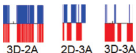
Рис. 49. Флуктуации интенсивности флуоресценции Д-А пар различного типа (см. рис.34, 39, 45).
