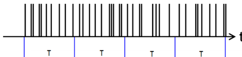
Рис.5. Последовательность фотонов флуоресценции двухуровневой молекулы на временной оси. На каждом интервале накопления сигнала T излучается разное число фотонов.
