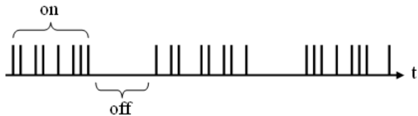
Рис. 10. Последовательность фотонов мерцающей флуоресценции трёхуровневой молекулы.
