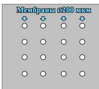
Рис. 55 Схема массива мембран диаметром 200 мкм на одной подложке.
