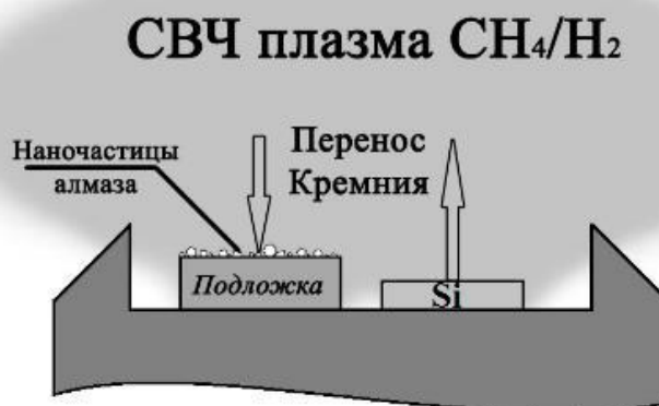
Рис. 70 Схема процесса переноса кремния с пластинки Si в алмазную пленку.
