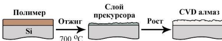
Рис. 12 Схема процесса получения алмазной пленки с использованием полимерных прекурсоров.
