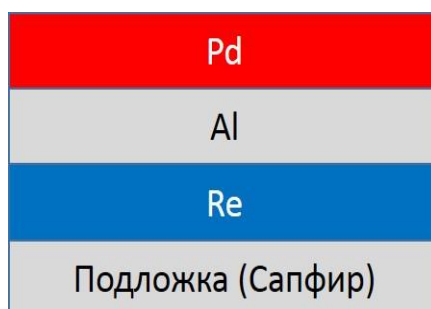
Рис. 5.1. Схема организации образца тонкопленочной слоистой структуры AlPdRe.
