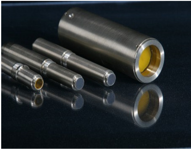
Рис. 2.2 (а). Поликапиллярные линзы, используемые в качестве коллиматоров (фото). Справа – фотография стеклянных капилляров [111].
