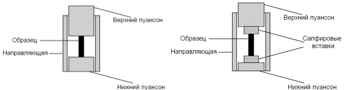
**Рис. 33** Схема оснастки для испытаний на сжатие образцов керамики SiC-C-Si при температуре 20°C (слева) и 1000°C (справа)
