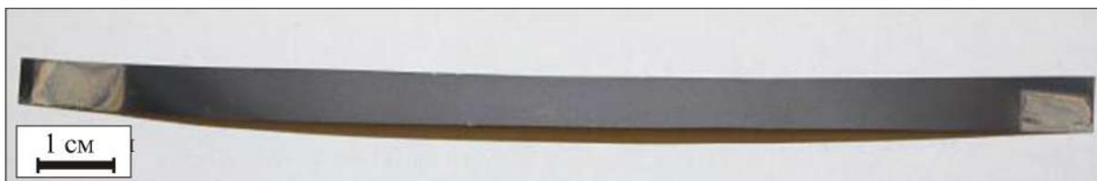
**Рис. 65** Защитное газоплотное SiC покрытие на нагревательном элементе из молибдена
