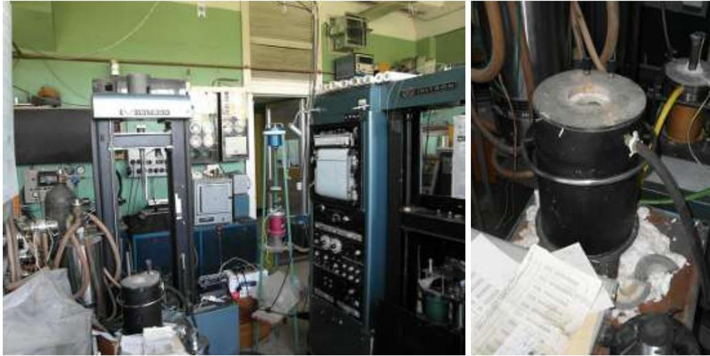
**Рис. 31** Установка Instron для механических испытаний при температуре 1000°C. Справа показана трубчатая печь для нагрева образцов
