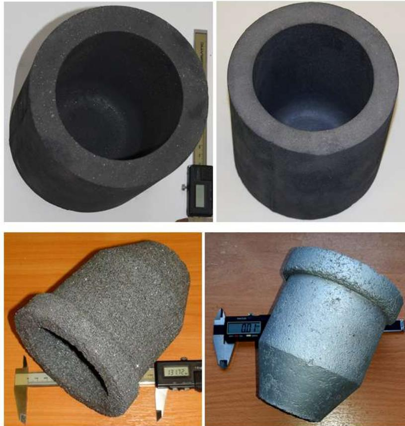
**Рис. 51 Крупногабаритные изделия из модифицированной карбидокремниевой керамики, слева до модификации, справа после модификации**
