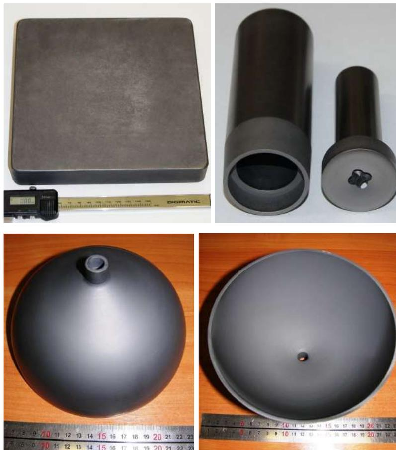
**Рис. 56 Газоплотные SiC покрытия на графитовых крупногабаритных деталях. Толщина покрытия составляет 20-30 мкм**
