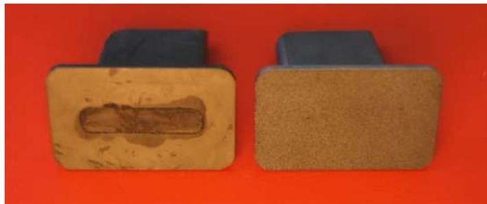
Рис. 40 Слева направо: склеенные детали, готовое изделие из SiC-C-Si материала
