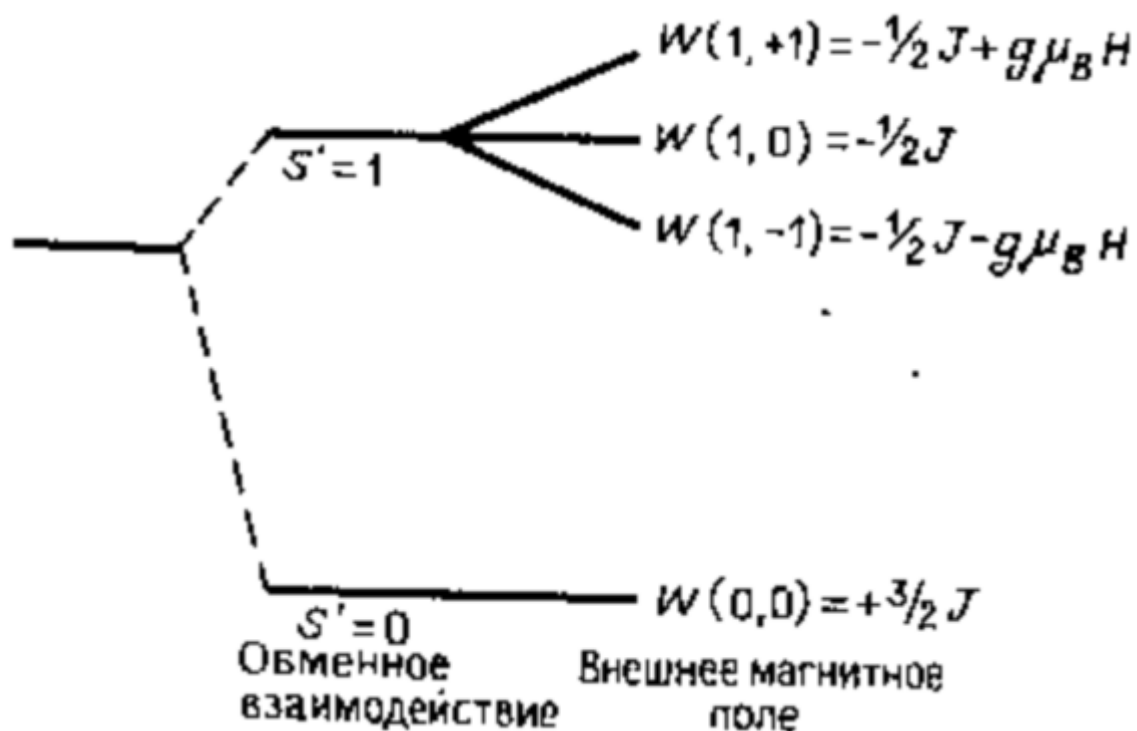
Рис. 1.1. Система уровней димера, состоящего из ионов с спином S = 1/2 . Справа показано расщепление уровней в магнитном поле [26].
