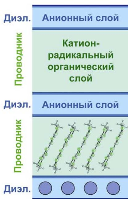
**Рис. I-1. Схема образования низкоразмерных молекулярных проводников на основе катион-радикальных солей органических  $\pi$ -доноров**
