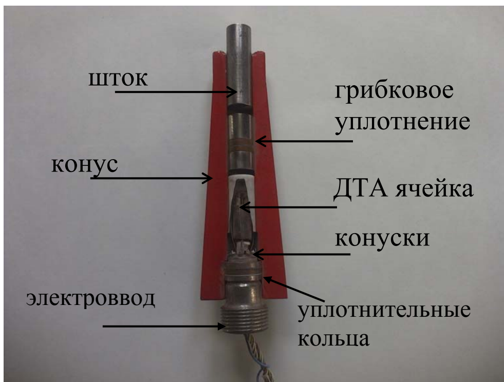
Рисунок 1.2. Фотография модельной камеры конусного типа, используемой при ДТА измерениях.
