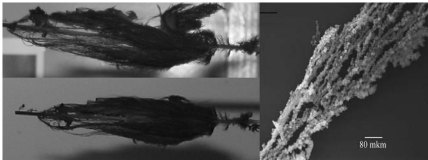
Рис. 43. Структура углеродных перемычек растущих на центральном электроде, справа – изображение сканирующего электронного микроскопа, слева – оптическое.
