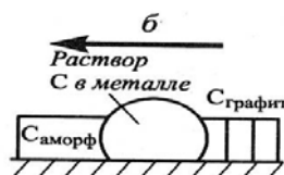
Рис. 12. Схема каталитической графитизации аморфного углерода в присутствии наночастицы металла (Стрелка вверх указывает направление движения флуидизированной частицы) [39]
