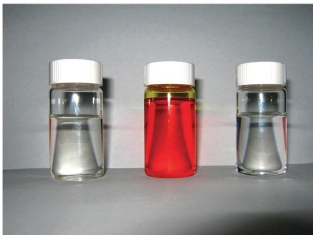
Рис. 8. Изменение цвета раствора донорно-акцепторной смеси при формировании КПЗ. (а) (из [67]) Смесь прозрачных растворов 1-метилнафталена (слева) и 1-этил-4-цианопиридин бис((трифторметил)сульфонил)имида (справа) приобретает ярко красную окраску (в центре). (б) Образование КПЗ в смеси МЕН-PPV:TNF приводит к существенному потемнению раствора. Слева: смесь МЕН-PPV:TNF, справа: чистый МЕН-PPV. Раствор акцептора TNF имеет слегка желтоватую окраску.
