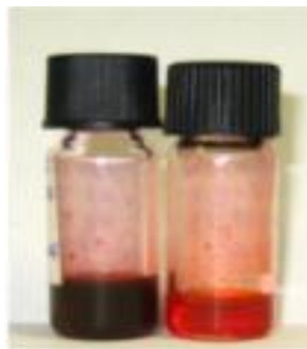
Рис. 8. Изменение цвета раствора донорно-акцепторной смеси при формировании КПЗ. (а) (из [67]) Смесь прозрачных растворов 1-метилнафталена (слева) и 1-этил-4-цианопиридин бис((трифторметил)сульфонил)имида (справа) приобретает ярко красную окраску (в центре). (б) Образование КПЗ в смеси МЕН-PPV:TNF приводит к существенному потемнению раствора. Слева: смесь МЕН-PPV:TNF, справа: чистый МЕН-PPV. Раствор акцептора TNF имеет слегка желтоватую окраску.
