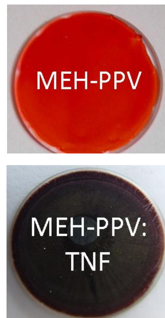
Рис. 10. а) Спектр солнечного света AM1,5G (черная кривая) и спектры поглощения ПП МЕН-PPV и КПЗ МЕН-PPV:TNF. б) Внешний вид пленок чистого полимера МЕН-PPV (вверху) и МЕН-PPV:TNF (внизу).
