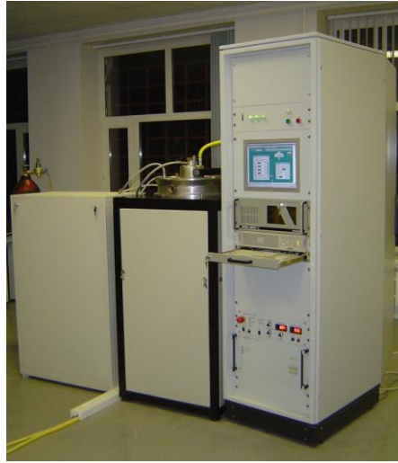
Рис. 3. СВЧ реактор «Ardis-100» для синтеза поликристаллических алмазных плёнок, разработанный совместно ИОФ РАН и ООО «Оптосистемы» (г. Троицк, Москва).
