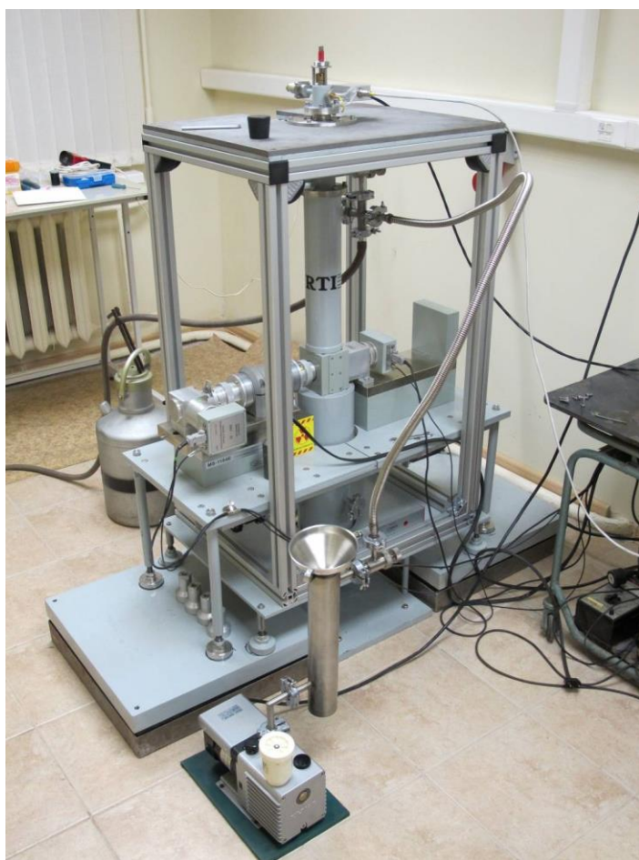
Рисунок 23. Спектрометр MS-1104Em с гелиевым безжидкостным криостатом замкнутого цикла (интервал температур 4.2-295 K).
