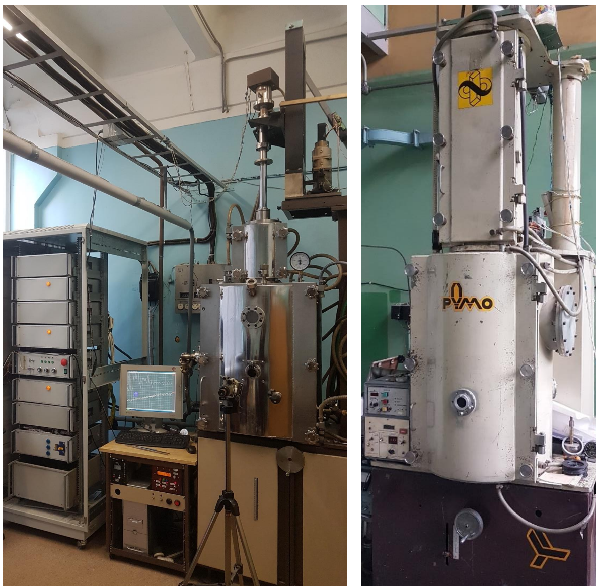
Рисунок 31 — Установки НИКА (слева) и РУМО-1С (справа) для выращивания профилированных кристаллов из расплава.
