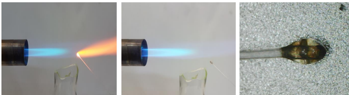
Рисунок 47 — Наплавление стеклянного шарика на сапфировое волокно.
