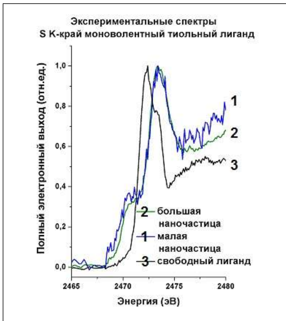
Рисунок 3.4 - Спектры рентгеновского поглощения XANES за K-краем S в свободных моновалентных тиольных лигандах и связанных с наночастицами Au разного размера
