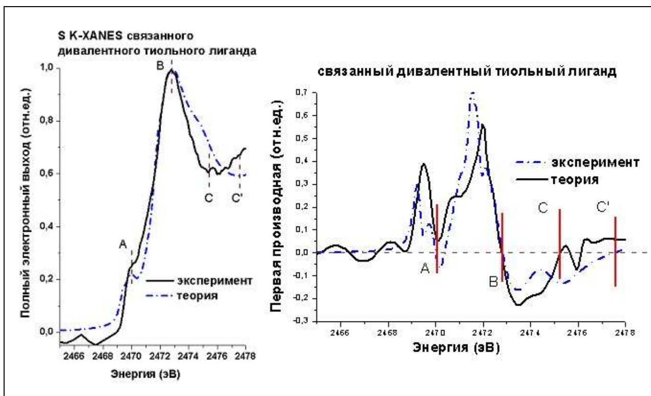
Рисунок 3.21 - Экспериментальный и рассчитанный спектры S K-XANES связанного с наночастицей Au дивалентного тиольного лиганда. Справа – первые производные спектров
