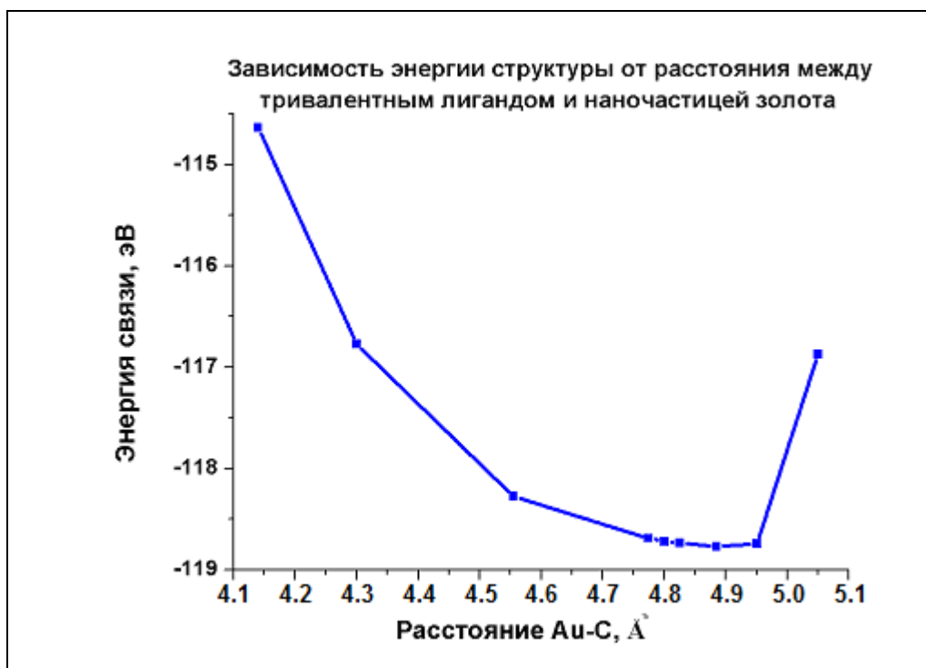
Рисунок 3.15 - Зависимость энергии структуры, состоящей из тривалентного тиольного лиганда, связанного с поверхностью наночастицы золота, от расстояния между атомом серы лиганда и атомом золота на поверхности наночастицы, с которым он образует связь
