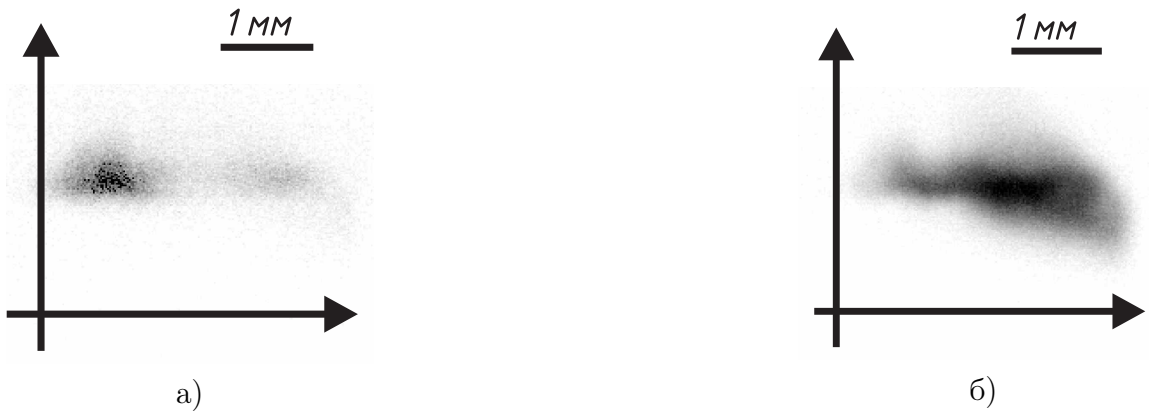
Рисунок 1.16 — Фотографии «тёмной» МОЛ [55]. а) — изображение, полученное при подсветке атомов «дырявыми» пучками МОЛ, имеющими пространственную моду LG_{10} ; б) — при подсветке пробным пучком с пространственной модой TEM_{00} . Видно, что облако имеет неправильную форму.
