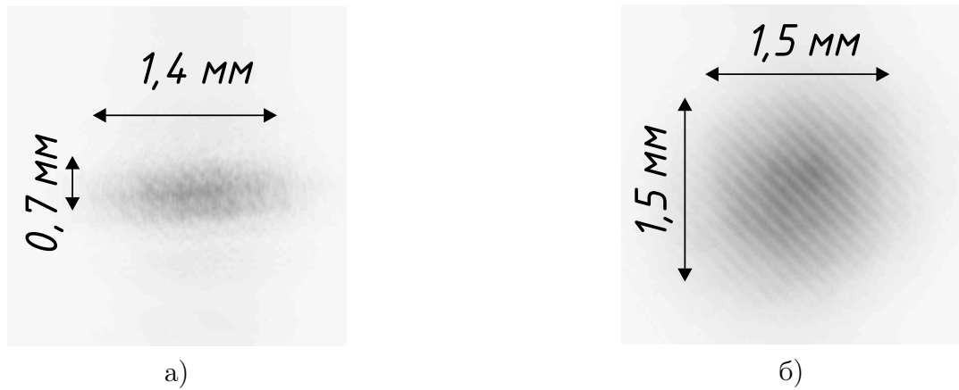
Рисунок 1.4 — Параметры лазерного пучка до а) и после б) цилиндрического телескопа. Квадратики — радиус перетяжки пучка по горизонтали, кружочки — по вертикали; сплошные линии — аппроксимация формулой r(z) = r(z_0)\sqrt{1 + (z - z_0)^2(\frac{\lambda}{\pi\omega})^2} [53].
