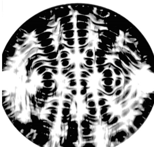
Рис. 1.5. топограмма кристаллического кварцевого резонатора в котором возбуждены ультразвуковые колебания с амплитудой 80 \text{ мкА/мм}^2 . Хорошо заметны ангармонические деформации.
