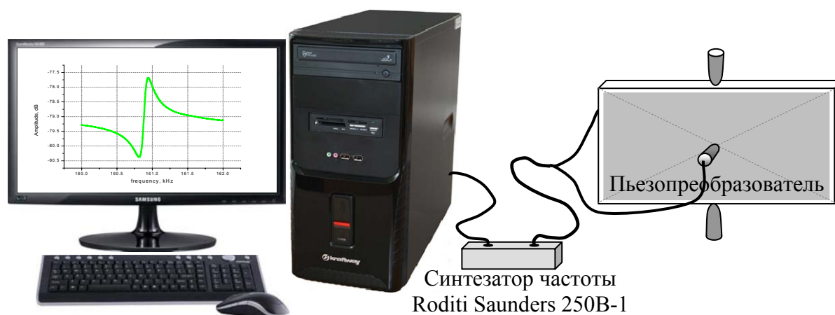
Рис. 3.9 Схема установки для измерения АЧХ и крепление кристалла-преобразователя в кристаллодержателе.
