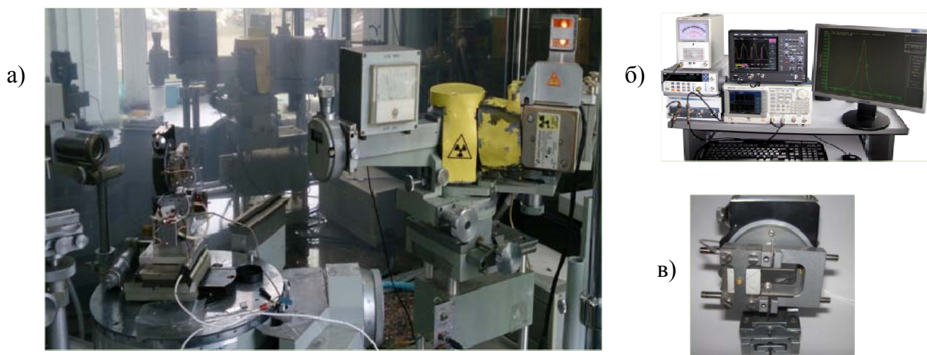
Рис. 4.1. а) Общий вид разработанного рентгеноакустического дифрактометра; б) Система возбуждения ультразвука и временного анализа рентгеновского сигнала; в) Кварцевый рентгеноакустический монохроматор;
