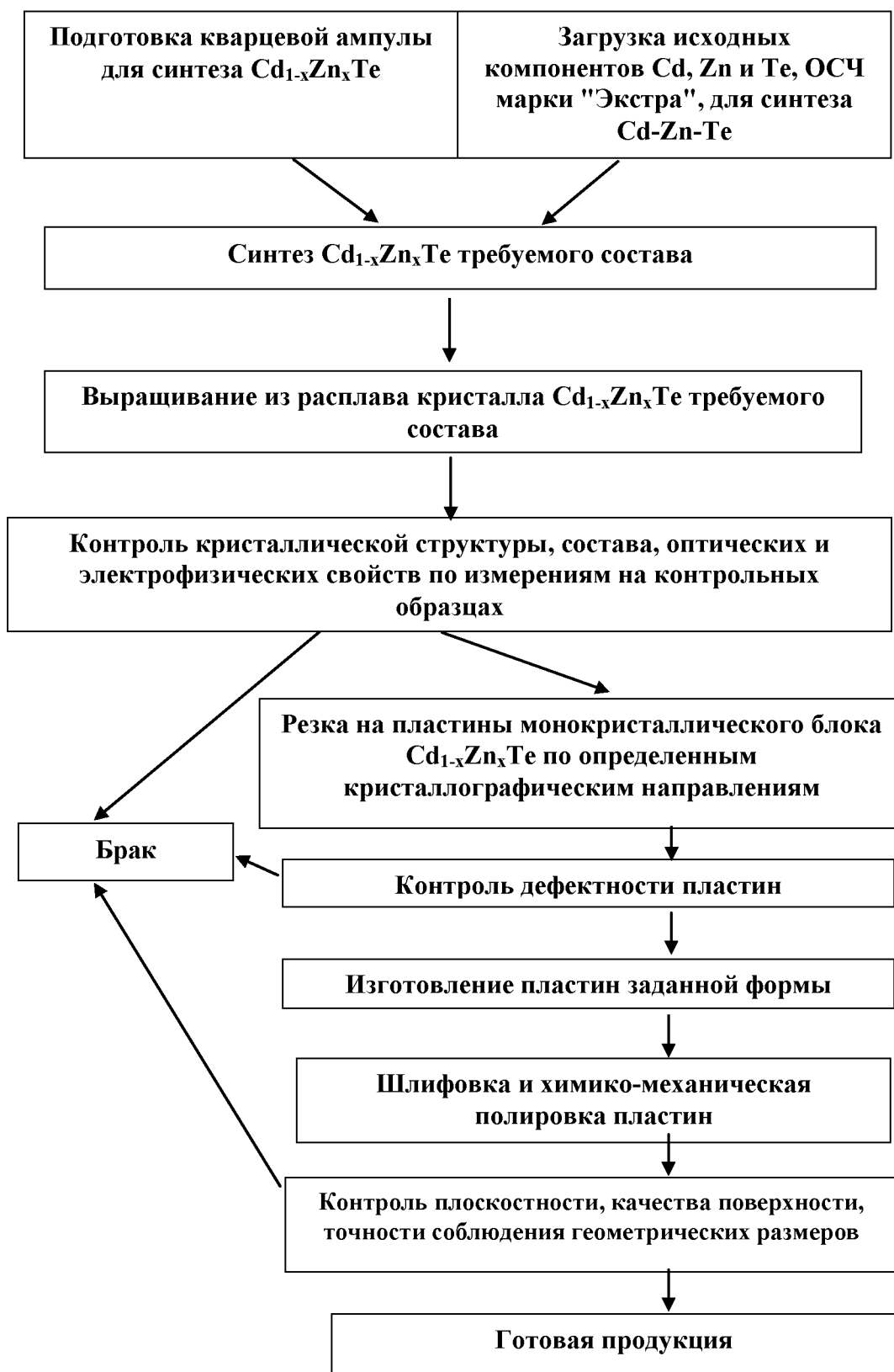
Рис.14. Технологическая схема получения материала из монокристаллического Cd_{1-x}Zn_xTe
