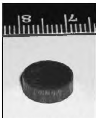
Рис.10 Керамическая заготовка, полученная из нанопорошка CdTe
