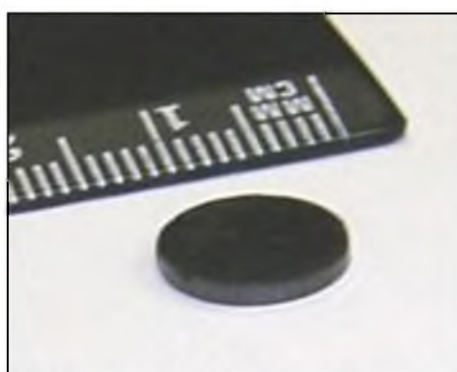
Рис.13. Керамический диск, спрессованный из нанопорошка Cd_{0,9}Zn_{0,1}Te
