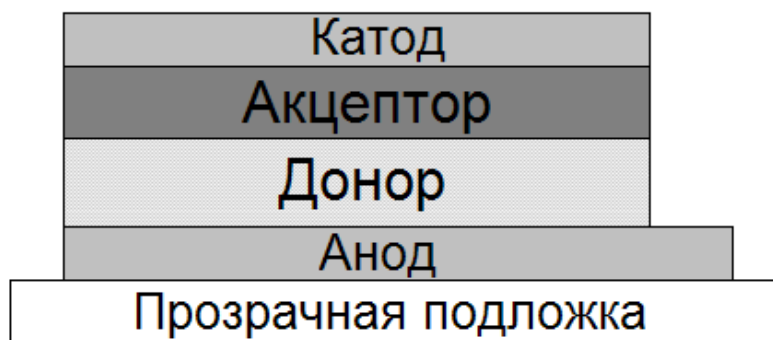
Рис. 4. Схема двухслойного органического фотоэлемента. Активный слой содержит два параллельных слоя донорного и акцепторного материала.
