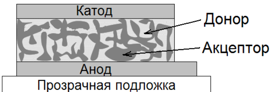
Рис. 6. Фотоэлемент с объёмным гетеропереходом. Активный слой представляет собой взаимопроникающую сеть фаз донора и акцептора.
