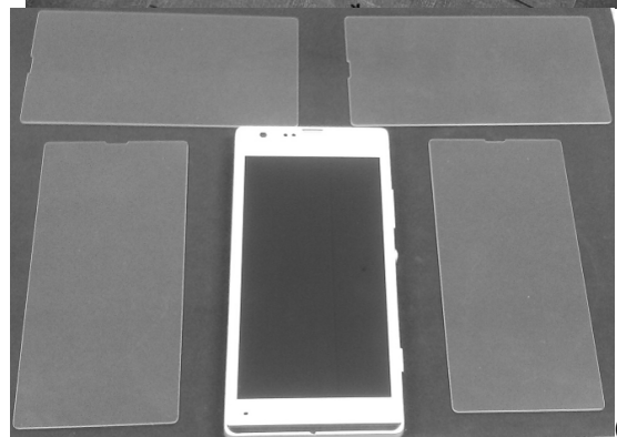
Рис. 5.5. Пакет из 16 сапфировых лент (а), относительный размер пакета лент (б, в) и заготовки сапфировых защитных экранов современных смартфонов, изготовленные из полученных кристаллов (г)
