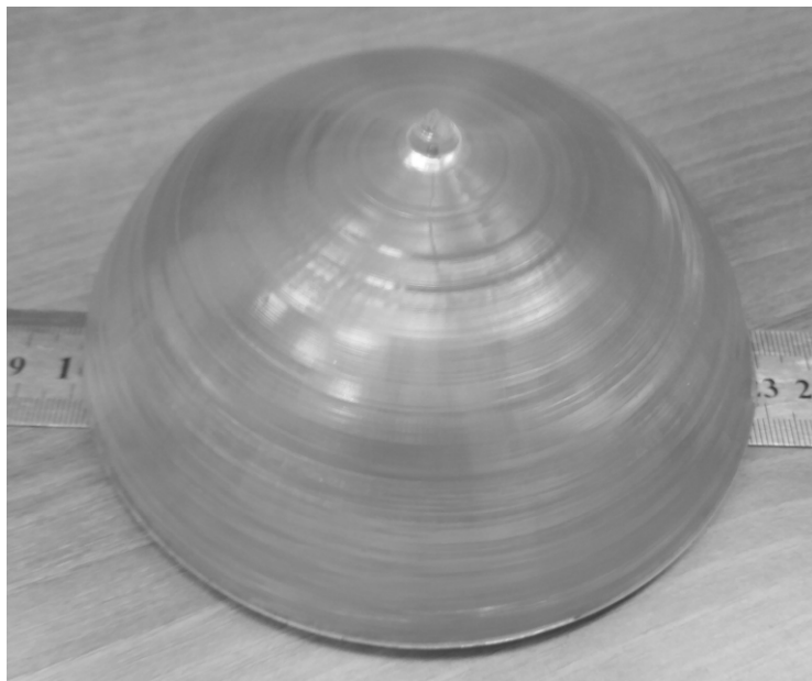
Рис. 3.7. Формообразующее устройство и кристалл в форме полусферы с диаметром основания 130 мм
