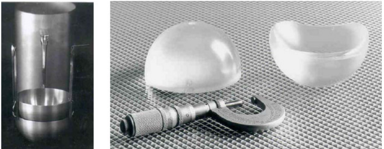
Рис. 1.4. Молибденовые изложницы и заготовки сапфировых обтекателей, полученные компанией Crystal Systems с помощью модифицированного НЕМ метода
