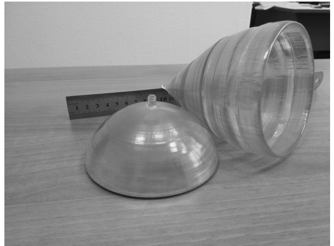
Рис. 3.8. Сапфировые заготовки в виде полых тел вращения, полученные методом локального динамического формообразования.
