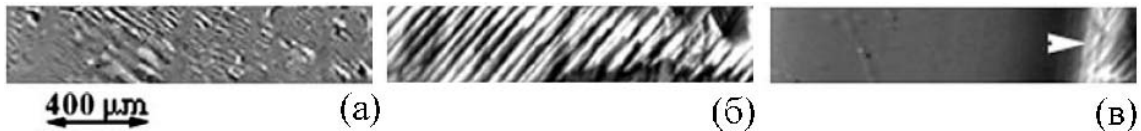
Рис. 1.12: Спонтанная доменная структура монокристалла \text{La}_{0.75}\text{Sr}_{0.25}\text{MnO}_3 при T = 80 \text{ K} – (а), тот же участок образца в плоскостном поле 2000 \text{ Э} – (б) и тот же участок при протекании тока – (в), [83]. Под действием приложенного поля доменная структура (а) исчезает и выявляется вариация величины намагниченности насыщения, коррелирующая с полосами роста кристалла (б). При протекании тока происходит локальный перегрев кристалла, часть образца переходит в парамагнитное состояние. Эта область кристалла не дает контраста (серый участок), а на границе между парамагнитной и ферромагнитной фазами появляется яркая область, соответствующая концентрации магнитного поля, „втягиваемого“ в ферромагнитную область, и все ещё видны магнитные неоднородности – (в).
