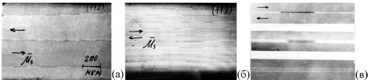
Рис. 2.43: Влияние способа размагничивания на доменную структуру в пластине ИЖГ: структура после размагничивания полем частотой 50 Гц – (а) и охлаждением от температуры Кюри – (б); статическая и динамическая структура доменных границ – (в).
