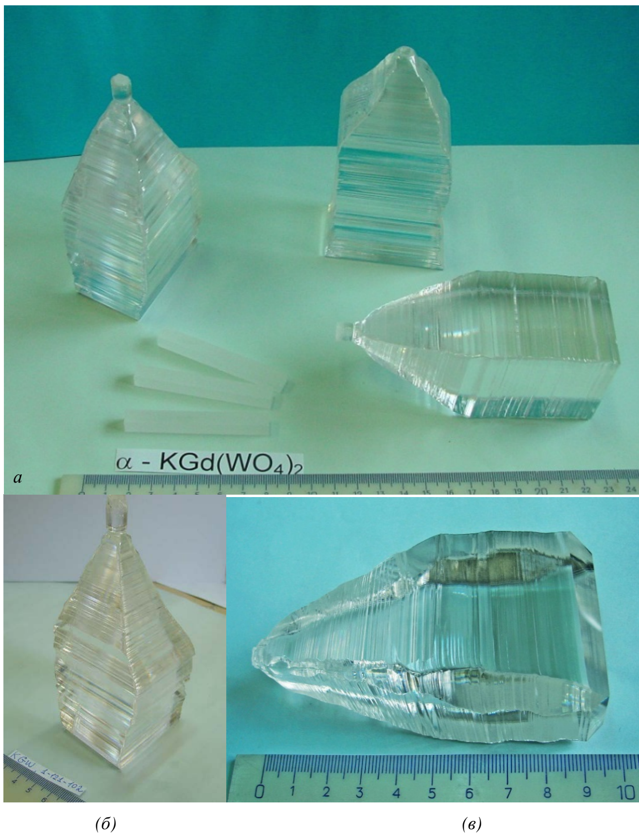
Рис. 1.5. Фото кристаллических образцов семейства \alpha\text{-KRE}(\text{WO}_4)_2 : а, б – \text{KGd}(\text{WO}_4)_2 ; в – \text{KLu}(\text{WO}_4)_2
