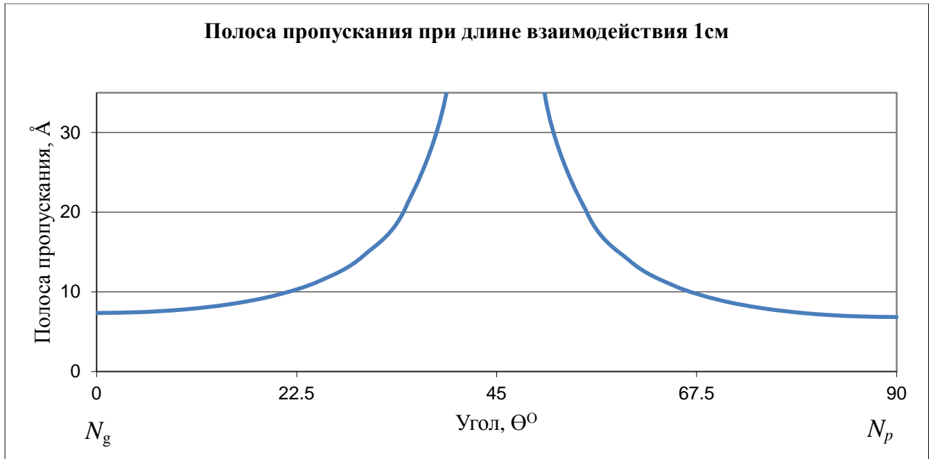
Рис. 3.11. Полоса пропускания \delta\lambda при коллинеарном взаимодействии в плоскости N_p N_g для кристалла KYbW, при длине взаимодействия L = 1 см.
