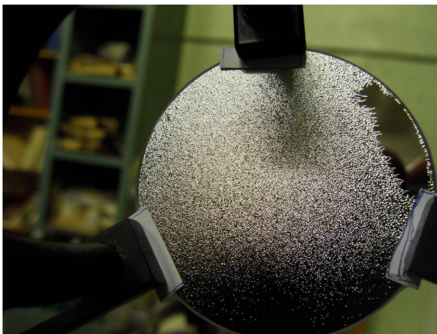
Рис. 3.5. Отслоение многослойной структуры в МЗ, в котором первым слоем на кварцевой подложке была сурьма.
