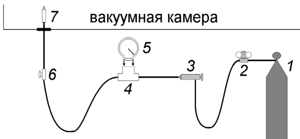
Рис. 1.6. Схема установки импульсного газового клапана 7 в вакуумной камере. 1 – баллон с рабочим газом; 2 – редуктор; 3 – вентиль тонкого напуска; 4 – буферный объём с возможностью подключения вакуумметра 5; 6 – вентиль грубого напуска.
