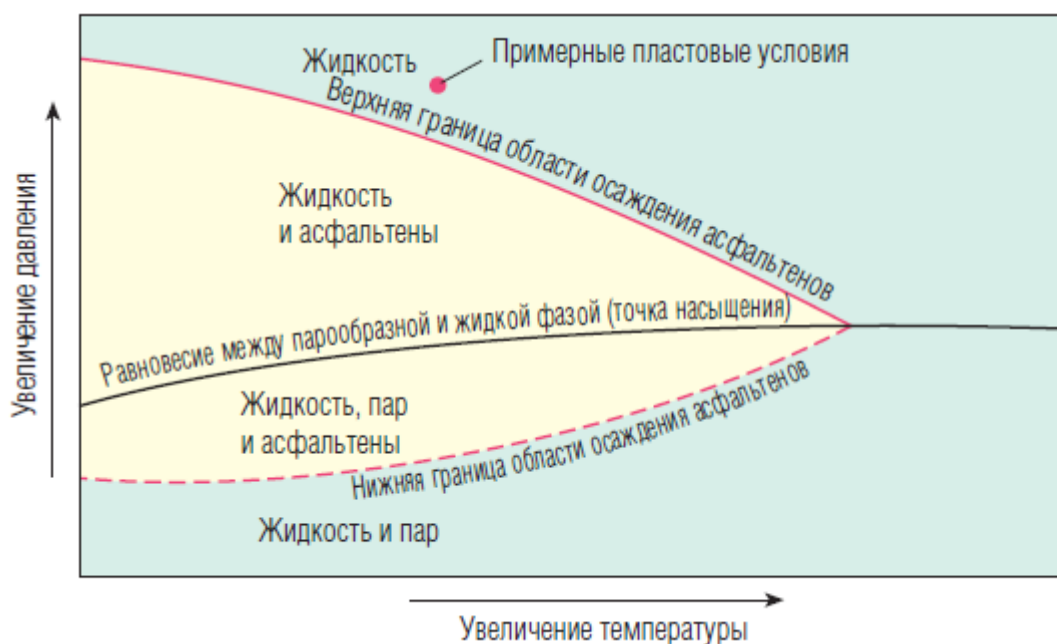
Рисунок 1.4. Диаграмма осаждения асфальтенов в координатах «давление – температура» [35].
