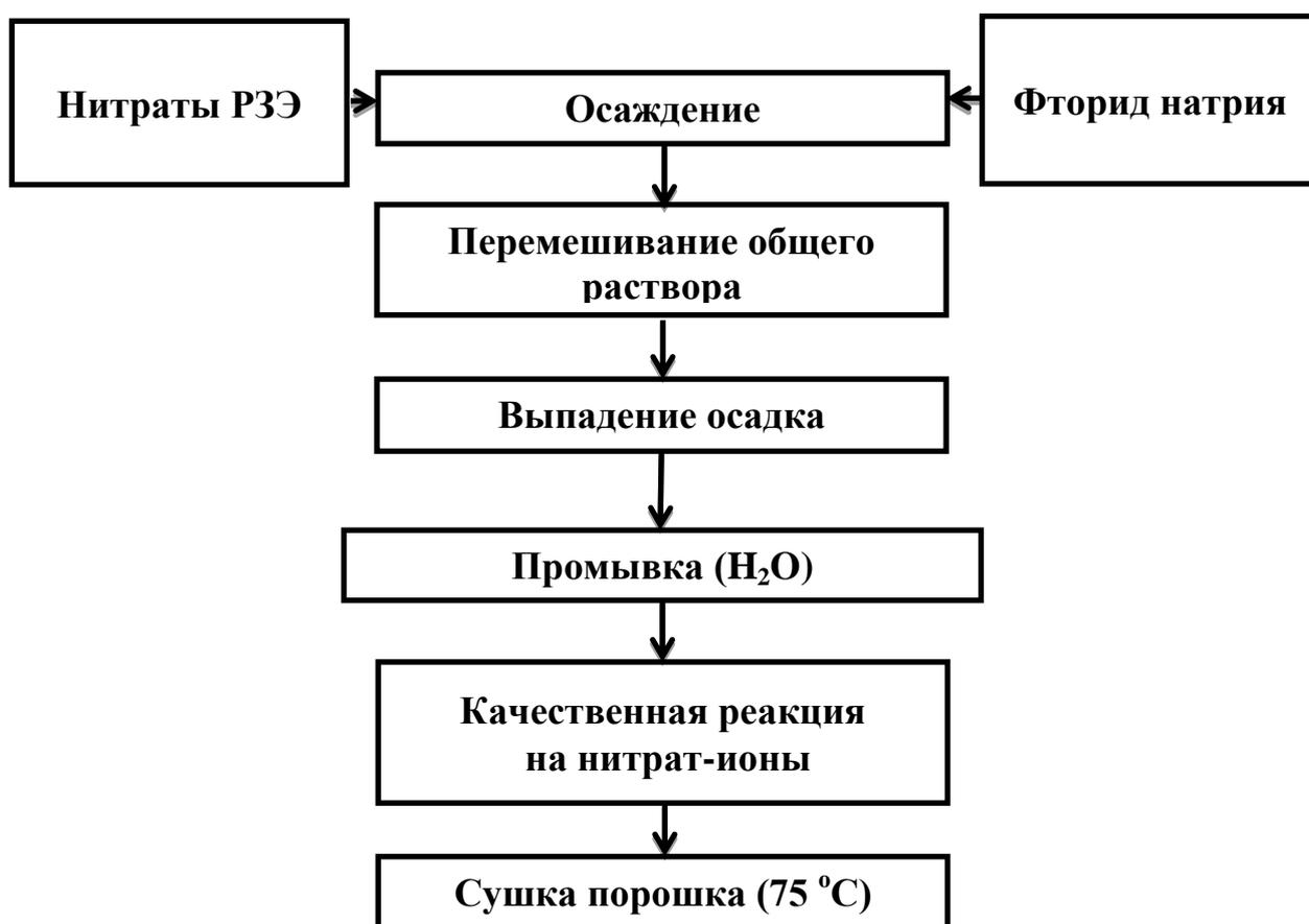
**Рис. 14. Общая блок-схема последовательных этапов синтеза методом осаждения из водных растворов.**
