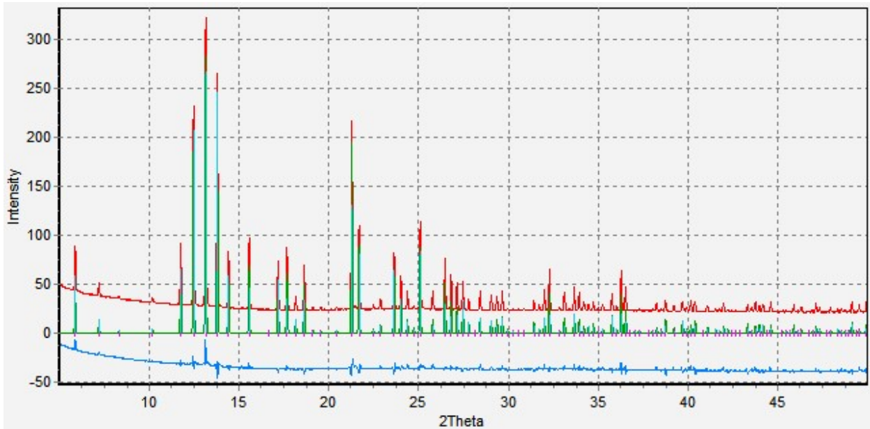
Рисунок 5 – Сравнение экспериментальной дифрактограммы \text{Bi}_3\text{FeO}_{11}\text{Sb}_2 (красная) с расчётной (зелёная), для найденной по МПГА и уточнённой по DDM структуры ( R_{\text{wp}} = 2,88 ; R\text{-DDM} = 6,62 ). В нижней части графика приведена линия разности (синяя).
