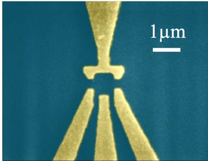
Рисунок 1.5 – Изображение металлических электродов (желтый цвет) на поверхности гетероструктуры, полученное в сканирующий электронный микроскоп. Изображение раскрашено искусственными цветами. Желтым цветом показаны золотые электроды.
