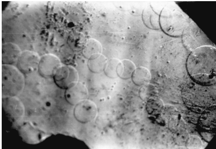
Рис. 2.2. Увеличенное изображение базисной поверхности (001) монокристалла \text{La}_2\text{CuO}_{4+x} .
