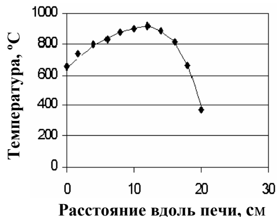
Рис. 17. Распределение температуры в печи для выращивания бикристаллов.
