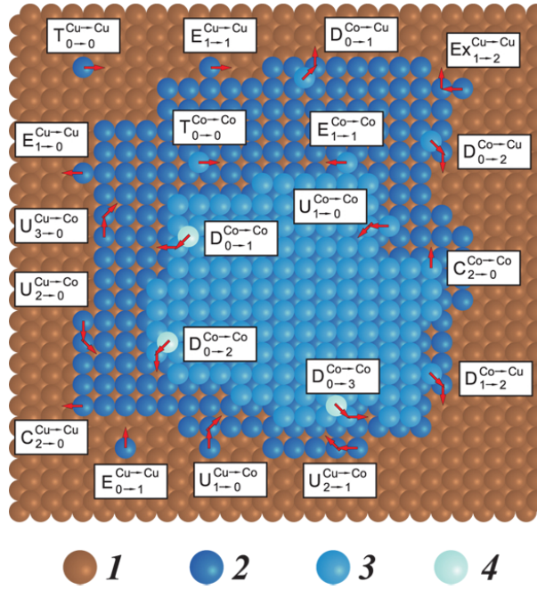
Рис. 3.2: Основные события, определяющие формирование кластеров Co на поверхности Cu(001) (вид сверху). 1 – атомы Cu, 2 – атомы Co в первом слое, 3 – атомы Co во втором слое, 4 – атомы Co в третьем слое.
