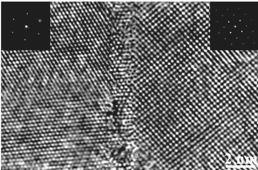
*Рис. 4.6 Высокорастворяющее изображение сплава  $Zr_{50}Ti_{16.5}Cu_{15}Ni_{18.5}$  после термической обработки при  $T = 773\text{ K}$*
