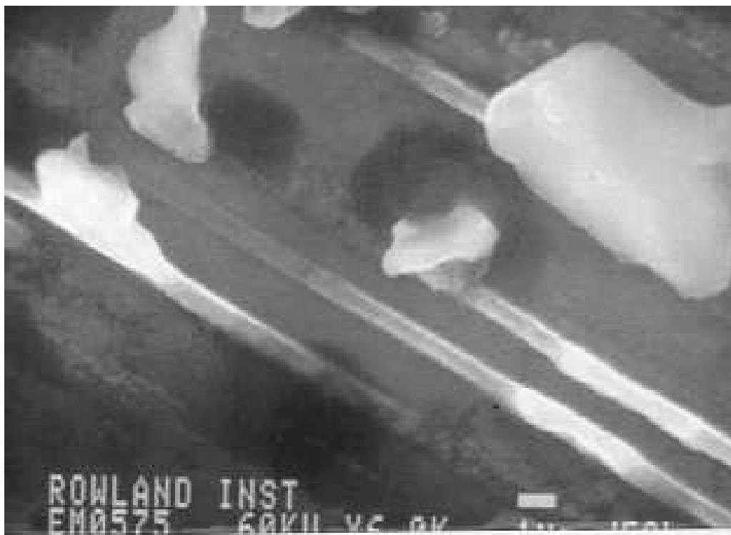
Рис. 3.9: Изображение поверхности кристалла Tl_2Ba_2CuO_{6+x} , полученное с помощью сканирующего электронного микроскопа.
