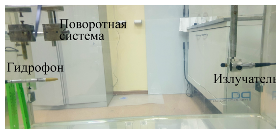
Рис. 2.10. Экспериментальная установка для измерения диаграммы направленности гидрофонов.
