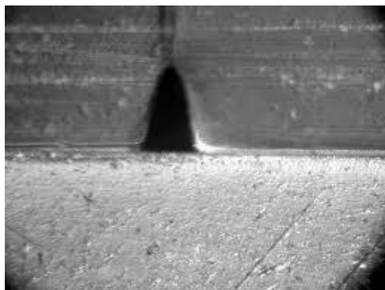
Рис.9. Спаянные термическим методом ПММА пластины
